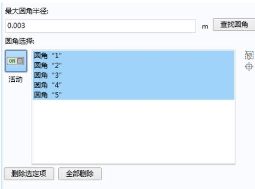
操作完成后，所有的圆角均被移除。注意**删除圆角 1 (dfi1)** 节点已插入几何序列中，位于**端盖 1 (cap1)** 节点正上方。**端盖 1 (cap1)** 节点目前仍不可用，表示当前并未构建。
